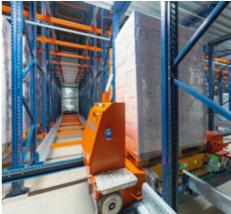
IN COMBINATION WITH STACKER CRANES, THE PALLET SHUTTLE SYSTEM CAN REACH A STORAGE HEIGHT OF UP TO 40 M.
